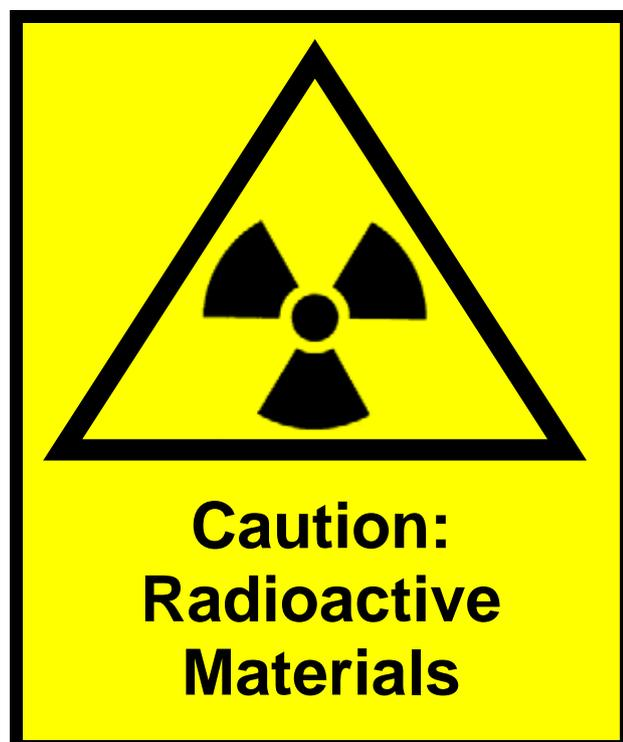
**H4 EXAMPLE OF A SUITABLE WARNING NOTICE FOR A STORE FOR RADIOACTIVE MATERIALS**
